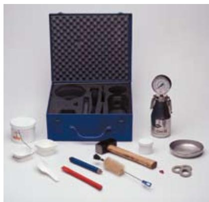
Procédez à plusieurs mesures pour avoir une bonne vue d'ensemble. Vérifiez également si le support a la même épaisseur partout. Plus la chape est épaisse, plus il faut de temps pour qu'elle soit complètement sèche. Un hygromètre électrique permet de déterminer les zones les plus humides, la mesure précise pouvant être effectuée à l'aide de l'hygromètre CM.
